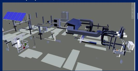
Вентиляция, отопление, кондиционирование, тепломеханическая часть
